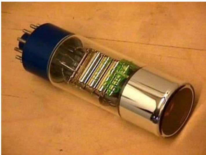
La tecnologia del fotomoltiplicatore, nata nel 1934 si basa sull'effetto fotoelettrico (1921 Einstein Premio Nobel) , e sull'emissione secondaria di elettroni. I fotomoltiplicatori sono oggetti costosi (Keuro) e da laboratorio, necessitano di tensioni dell'ordine dei 1000 Volt e sono molto fragili.
