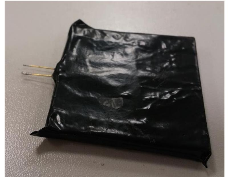
Sigillare alla luce esterna il rivelatore usando del nastro isolante.
