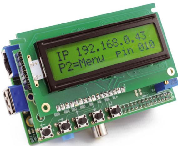
L'alimentazione a 5V viene prelevata dal piedino 2 del connettore GPIO di Raspberry Pi mentre la massa è collegata al piedino 6. Il trimmer multigiri presente sulla scheda permette di regolare il contrasto del display LCD.
