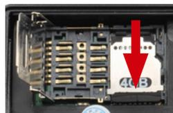
4) Inserire la SIM card nell'apposita sede orientandola come visibile nell'immagine a fianco, quindi abbassare la linguetta e bloccarla in posizione spingendola nel senso della freccia.
