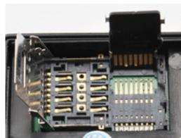
Abbassare la linguetta con la micro SD card e bloccarla in sede spingendola nel senso della freccia.
