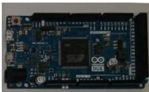
*Fig. 4 Scheda ARduino Due dotata di apposito firmware*
