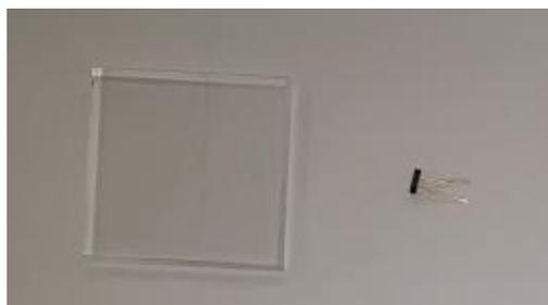
*Fig. 3 Rivelatore a Scintillatore e sensore SiPM
