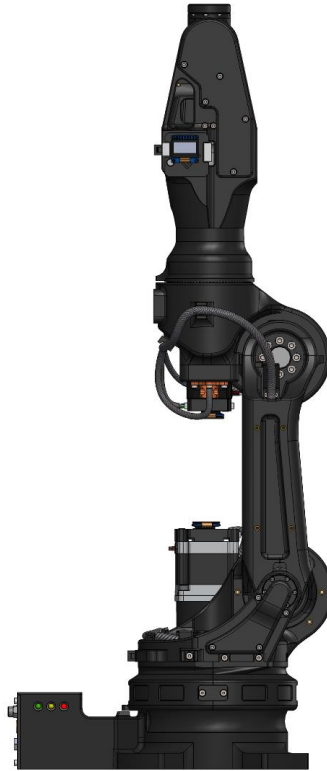
Posizione zero del braccio robotico Astorino.
