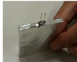
Ricoprirlo con una superficie riflettente (foglio di alluminio da cucina)
