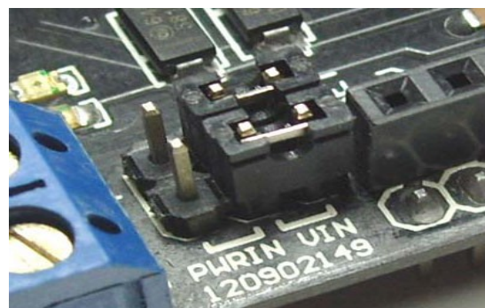
La motor shield riceverà l'alimentazione da Arduino
