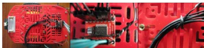
ora monta arduino fissandolo con due viti e due distanziali, il mio consiglio è di fare attenzione che dopo il montaggio sia facile collegare sia l'alimentazione proveniente dal lato inferiore sia il cavo USB per programmarlo:
